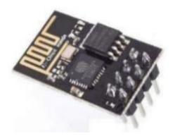
Figure 8 Wi-Fi module (ESP8266)
